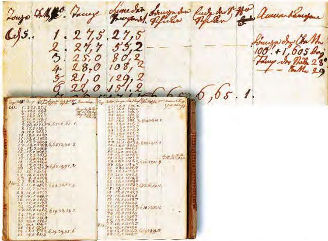
Angesichts des sumpfigen Terrains und der relativ primitiven, in allen drei Operationen verschiedenen Messmittel, welche damals zudem nur sehr schwierig geeicht werden konnten, ist die Differenz von 19 cm zwischen höchstem und tiefstem Wert (entspricht 0.0145‰) erstaunlich gering. Schweizer Präzision – schon damals!
